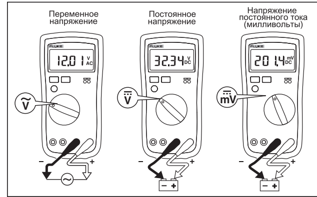
Рисунок 1. Измерение переменного и постоянного напряжения
